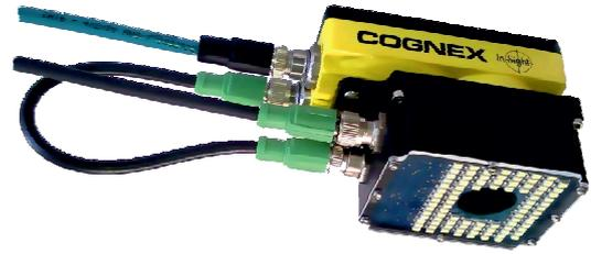
Durch die große Anzahl von LEDs und die Möglichkeit sehr kurzer Pulszeiten kann eine nahezu vollständige Unabhängigkeit von Fremdlichteinfüssen sichergestellt werden. Die Montage der Lampe direkt vor das Objektiv schützt dieses zudem vor Staub und Schmutz. Das vor den LEDs befindliche Acrylglasfenster ist auswechselbar, sodass im Falle von dessen Verschmutzung oder Beschädigung die ursprüngliche Bildqualität wiederhergestellt werden kann.
