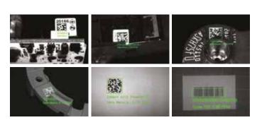
1DMax mit Hotbars-Technologie gewährleistet extrem schnelles Lesen von beschädigten oder schlecht gedruckten 1-D Barcodes bereits ab einer Größe von 0,8 Pixel pro Modul (PPM).
